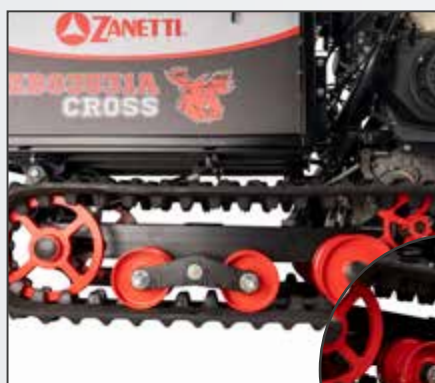
Robusto sottocarro con 3 rulli cingolo, 2 basculanti su bilanciere con punto di ingrassaggio
